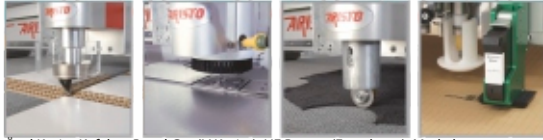
Özel Kesim Kafaları: Bevel Cut (V Kesim), HF Router (Frezeleme), Markalama, Driven Wheel (Teknik Tekstil), Baskı Kafası
