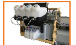
Dökme Boya Sistemi
